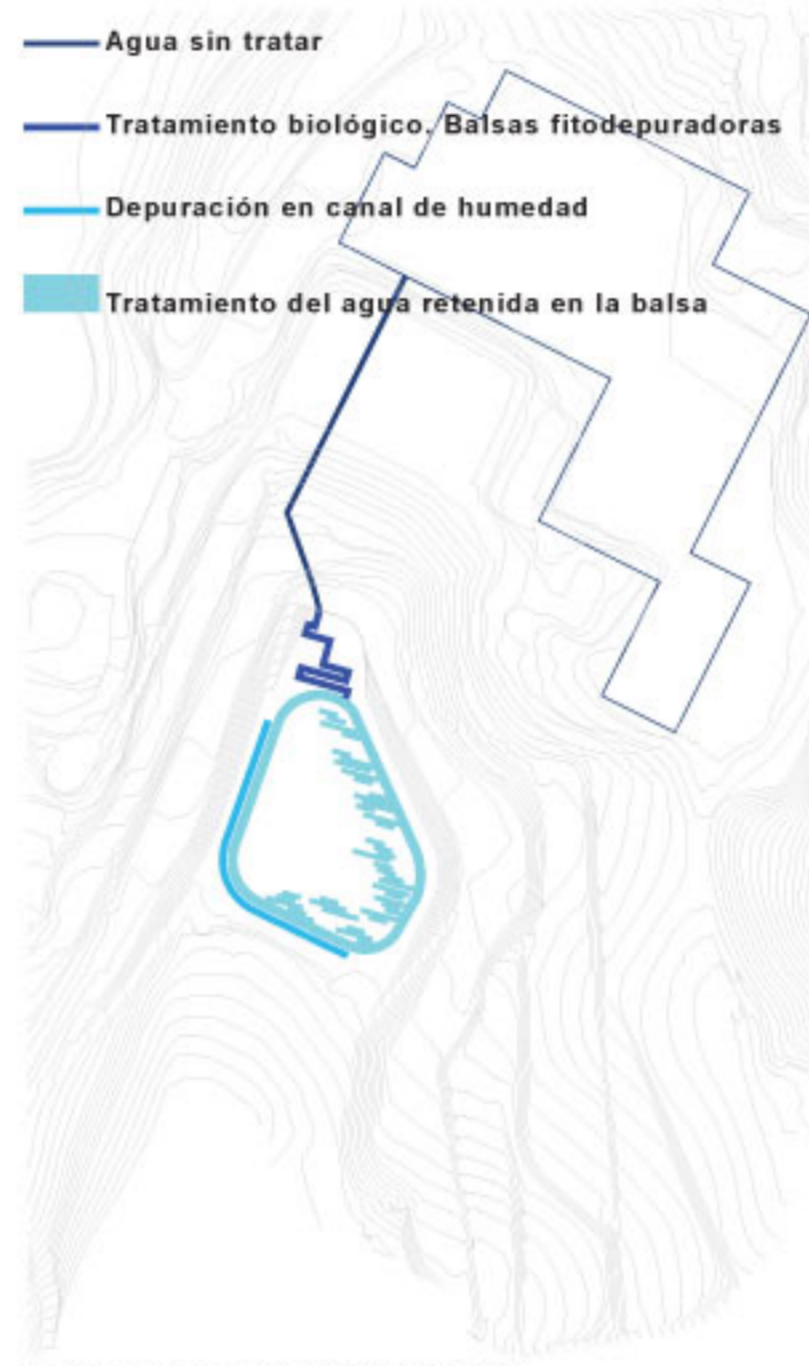
CIRCUITO DE FITODEPURACIÓN
